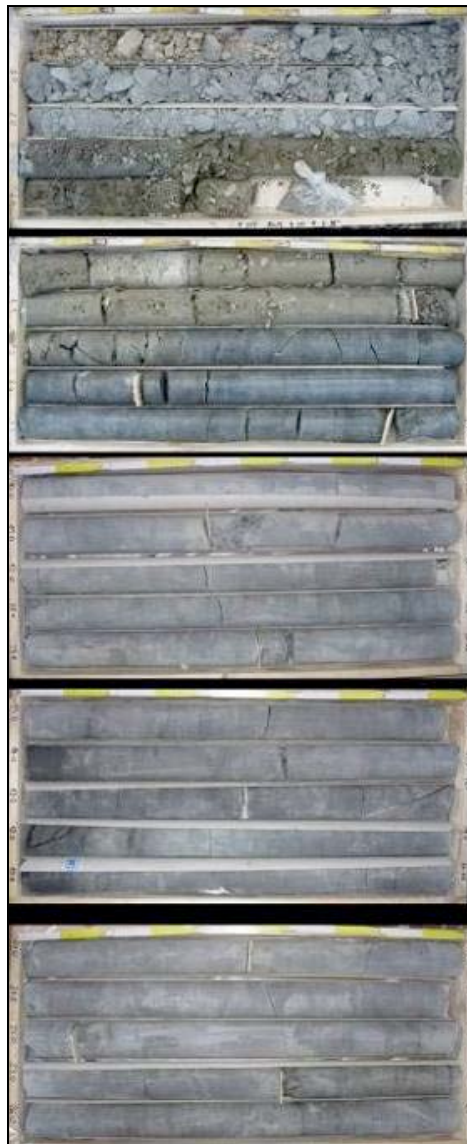
Figura 4 : Cassette catalogatrici di uno dei sondaggi; ogni cassetta contiene 5 carote di 1 metro di lunghezza.
